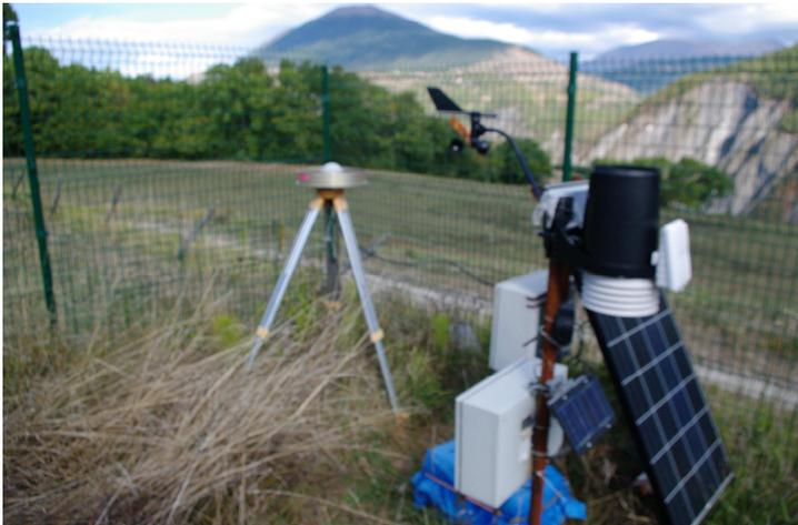
Centrale de mesure avec GPS et panneau photovoltaïque
