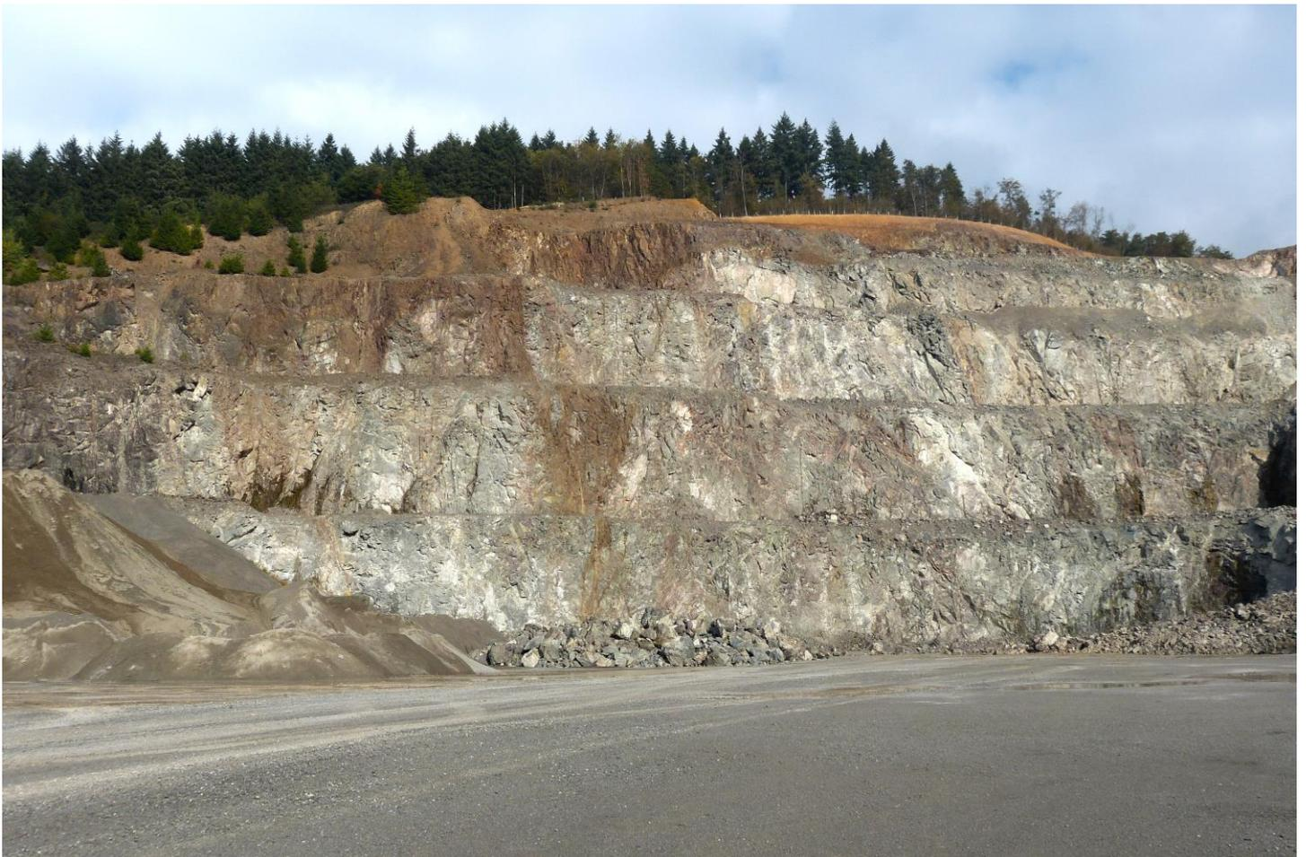
C'est une carrière encore en activité. La roche est un tuf rhyolitique datant du Viséen (340Ma). Toute la partie déboisement, défrichage et décapage sert au talutage. Il y a encore pour 30 ans de gisement. Le matériau est
